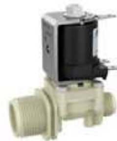
27.00x.126 DN 1,6 / DN 2 / DN 3; 0 - 10 / 0 - 8 / 0 - 3,5 bar; 1,5 / 2,5 / 4,8 l/min @ 1 bar
