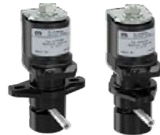
16.003.525 (NC) Silicone Tube 3x1; 60°Sh, 0 - 1,5 bar; 2,2 l/min @ 1 bar
